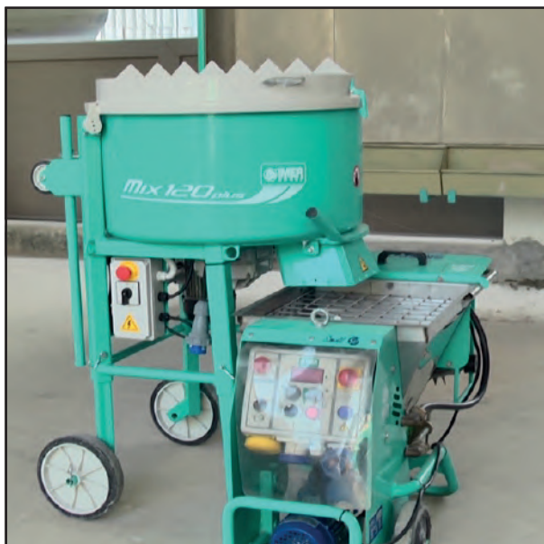
Alimentada por una mezcladora planetaria con doble sentido de giro, para múltiples tipos de materiales (Mezcladora IMER modelo MIX-120)
