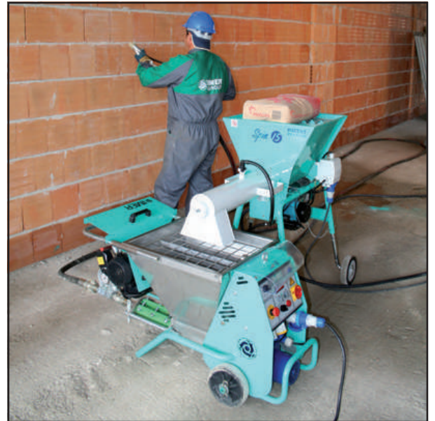
Alimentada por un mezclador continuo, para múltiples tipos de materiales premezclados (Mezclador IMER modelo SPIN-15 A)
