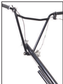
Manillares plegables ajustables a comodidad de los operarios.
