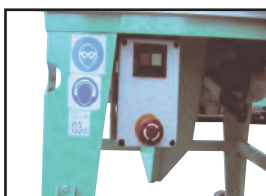
Interruptor con magnetotérmico regulable y bobina de baja tensión.
