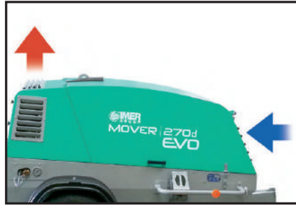
Sistema de refrigeración de flujo rápido (FAST-FLOW)
