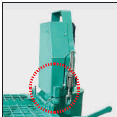
Sensor de seguridad para la apertura de la cámara de mezcla
