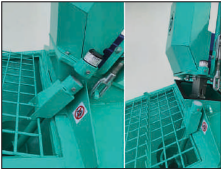
Sensor de seguridad en la rejilla de la tolva y en la basculación del motor del mezclador.
