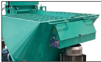
Nuevo diseño de la tolva que le otorga una mayor capacidad (140 l.)
