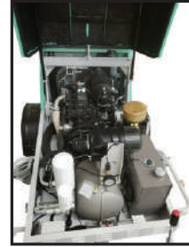
Motor Diésel Yanmar de 35 Kw, 4 cilindros. Acoplamiento directo motor a compresor
